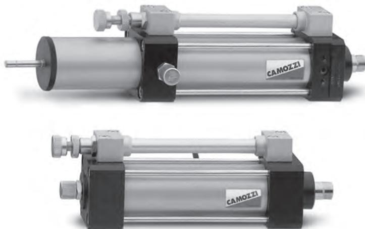
Стандартные гидродемпферы Серии 43 поставляются с двумя типами управления: регулируемым движением вперед с последующим быстрым отводом или быстрым движением вперед и регулируемым движением назад. Гидродемпфер поставляется вместе с заправленным расширительным бачком, который служит для устранения гидроударов. Управление скоростью осуществляется с помощью встроенного регулятора расхода, обеспечивающего возможность регулировки в широких пределах, и рассчитанного на непрерывный режим работы.
