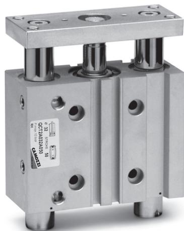
Обе модели оборудованы демпфированием в конце хода для предотвращения ударов поршня о крышки. Дизайн корпуса цилиндра позволяет его монтировать за любую поверхность. В Т-образные пазы возможно устанавливать магнитные датчики в различных положениях.
