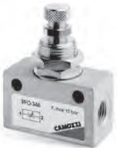
Пневмодроссели без обратного клапана предназначены для регулирования расхода воздуха в обоих направлениях, а так же для наполнения сжатым воздухом емкостей и для сброса давления в них. Модель выбирается по графикам, при этом необходимо заранее знать объем регулируемого воздуха в литрах на единицу времени.
