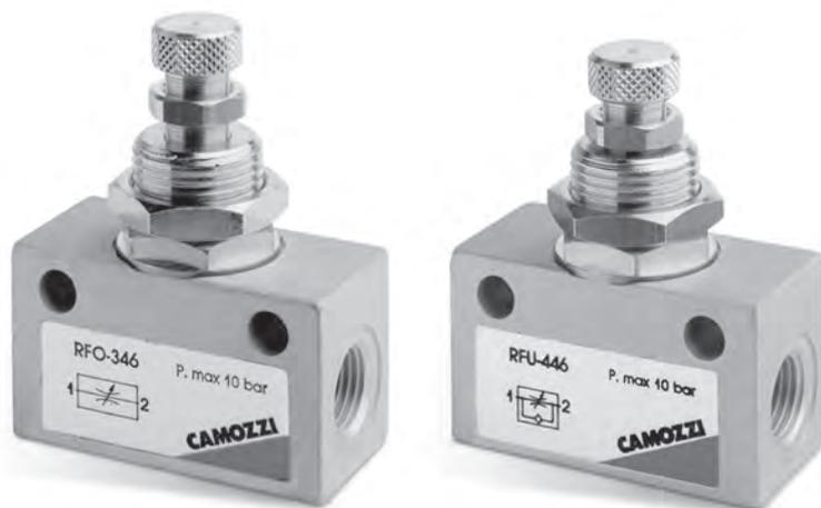
Пневмодросели с обратным клапаном поставляются с присоединительными отверстиями M5, G1/8 и G1/4, и имеют два исполнения - с обычной и повышенной расходной характеристикой (см. диаграммы). Они, в основном, используются для регулирования быстродействия цилиндров и могут монтироваться на панелях или, в случае необходимости, на цилиндрах и распределителях.
