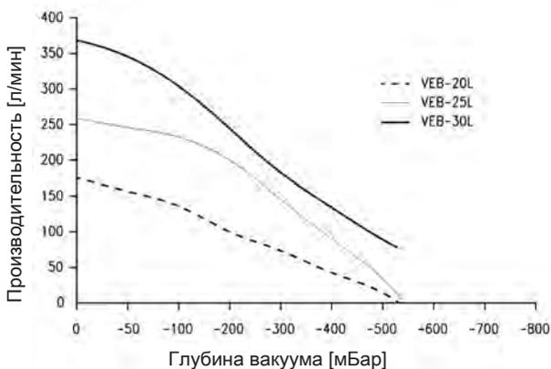
Зависимость производительности от глубины вакуума
