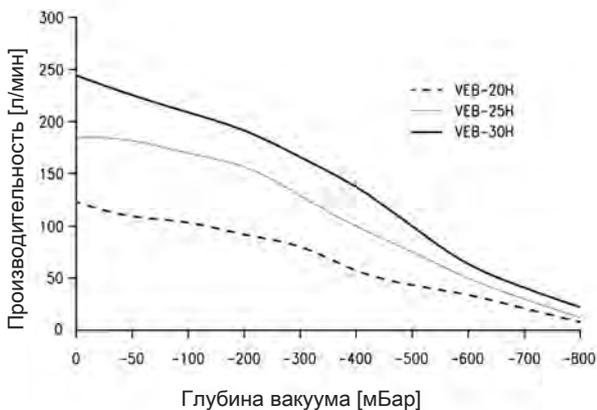
Зависимость производительности от глубины вакуума
