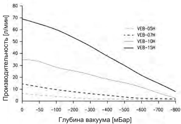
Зависимость производительности от глубины вакуума
