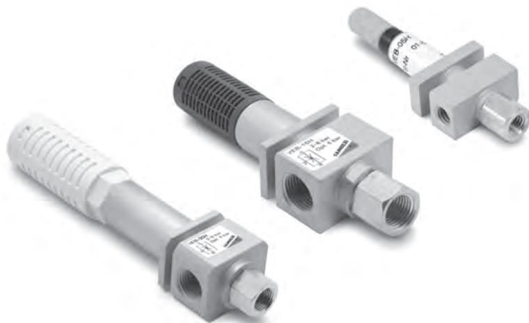
Вакуумные эжекторы Серии VEB являются универсальными и подходят для большинства промышленных задач. Они доступны в двух исполнениях: Исполнение "L" с увеличенной производительностью при малой глубине вакуума; Исполнение "H" для создания более глубокого вакуума (85%).
